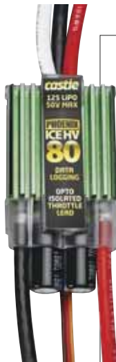
CSEM7500 Phoenix ICE HV Brushless ESC 80A
